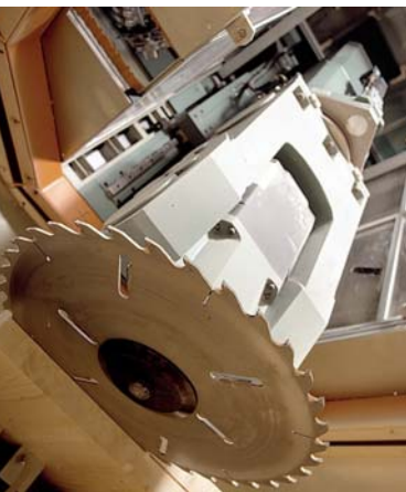
CNC gesteuerte Abbundanlage (CMS)
